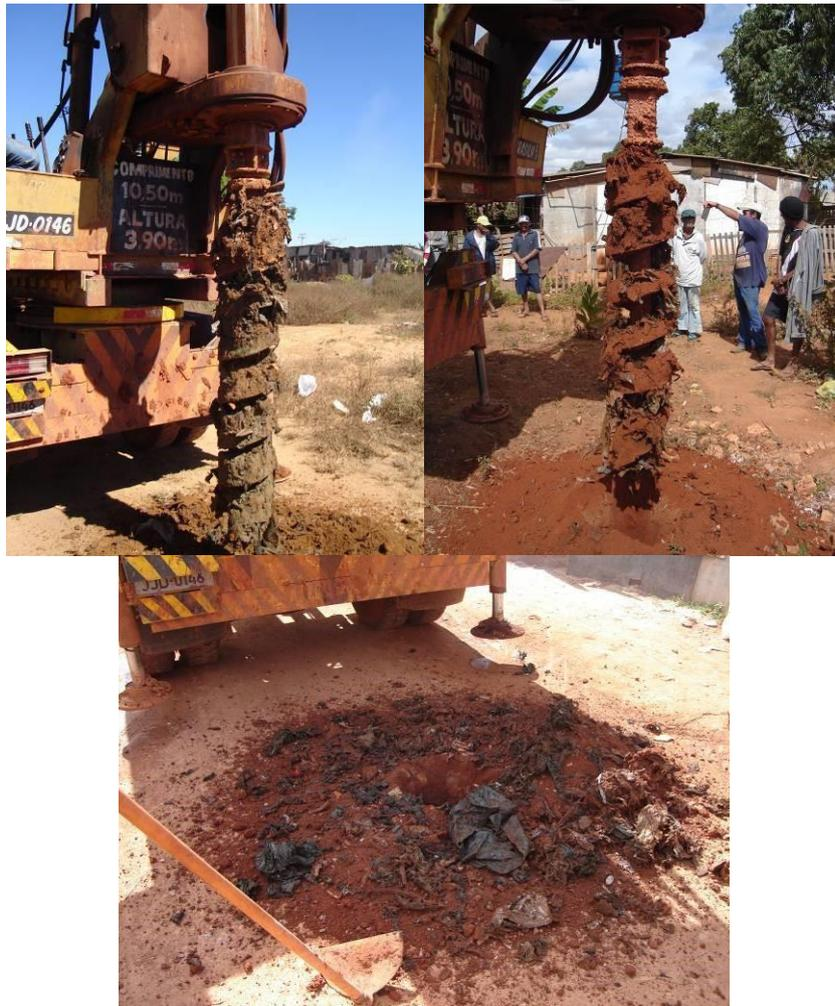
**Figura 24** - Fotografias de tipos de resíduos observados nas sondagens: lixo orgânico, lixo composto e lixo inorgânico (predominância de plástico). Além destes ainda ocorrem materiais metálicos, e blocos de concreto e restos de obras civis.
