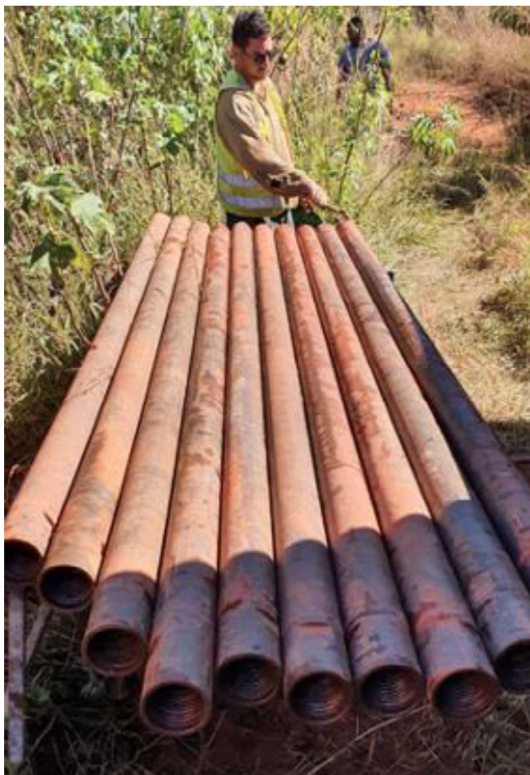
Figura 57 - Hastes com 3 metros de comprimento utilizadas para rotação tanto da broca tricônica como do bitter.
