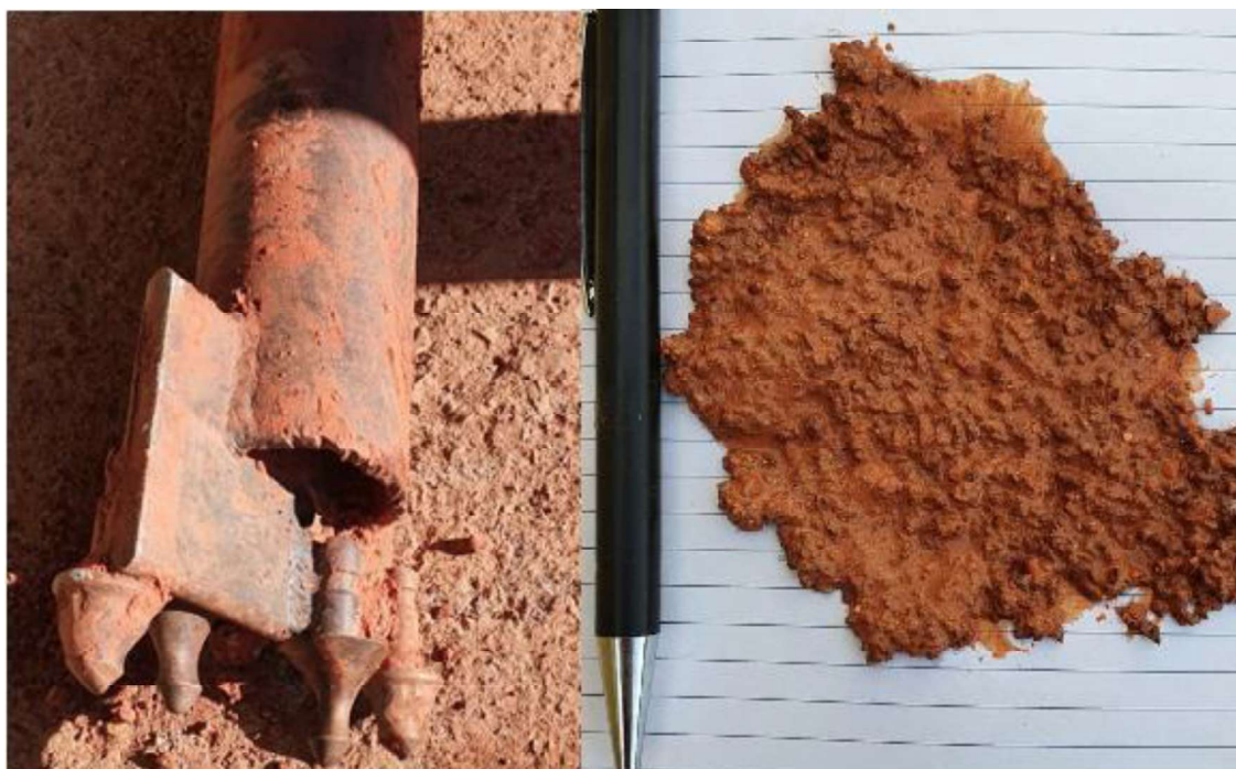
Figura 55 - Broca tricônica com 7 polegadas de diâmetro utilizada no método de circulação de lama. À direita, saprolito de ardósia da Formação Ribeirão do Torto, material geológico que permite a utilização dessa forma de sondagem.
