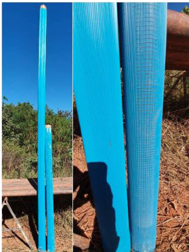
Figura 58 - Tubos de PVC geodinâmico utilizados para o revestimento dos poços. Os tubos lisos possuem 4 metros de comprimento, enquanto os filtros 2 metros. À direita, foto em detalhe mostrando as ranhuras dos filtros em comparação com os tubos lisos.
