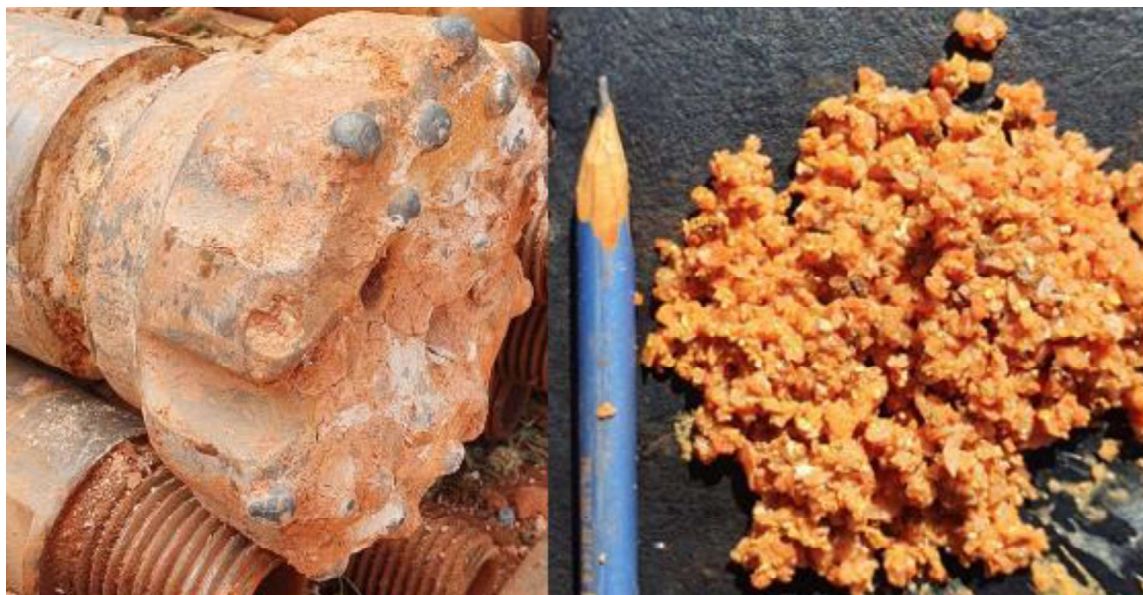
Figura 56 - Bitter de 8 polegadas de diâmetro utilizado no método roto-pneumático. À direita, saprolito de quartzito médio a grosso da Formação Ribeirão Piçarrão.
