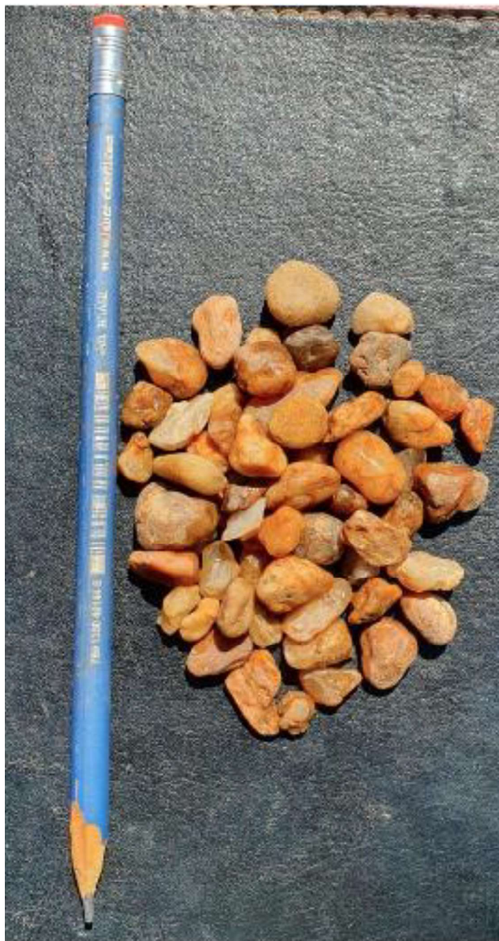
Figura 60 - Seixos de quartzo moderadamente selecionados e subarredondados usados como pré-filtro.
