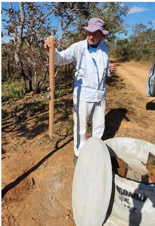
**Figura 35** - Amostragem de água no poço LX3 situado no Parque Nacional de Brasília. Notar o detalhe dos pesos acoplados no corpo do *bailer*. A água se apresenta turva, pois a obra do poço havia sido recém-concluída.
