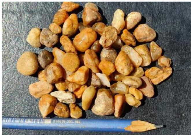
**Figura 32** - Detalhe do pré-filtro utilizado na maior parte dos poços.
