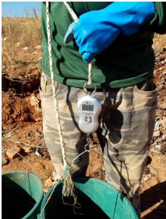
**Figura 61** - Detalhe de operação de pesagem com auxílio de corda e balança digital.
