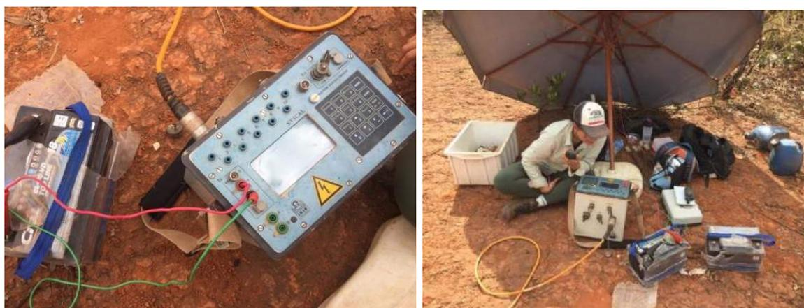
**Figura 25** - Fotografias mostrando o equipamento Syscal em atividade de levantamento de campo.
