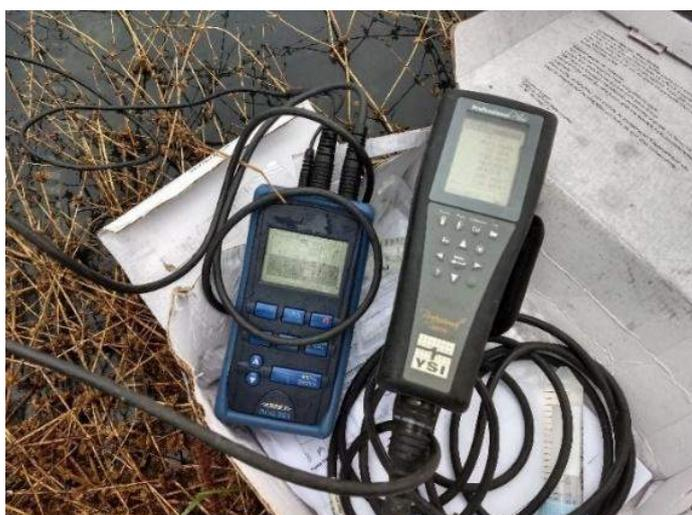
**Figura 36** - Sonda multiparâmetro YSI Professional Plus e sonda HQ 40d da Hach Instruments, utilizadas para coleta dos parâmetros (pH, temperatura, total de sólidos dissolvidos (TDS), e condutividade elétrica (CE)).
