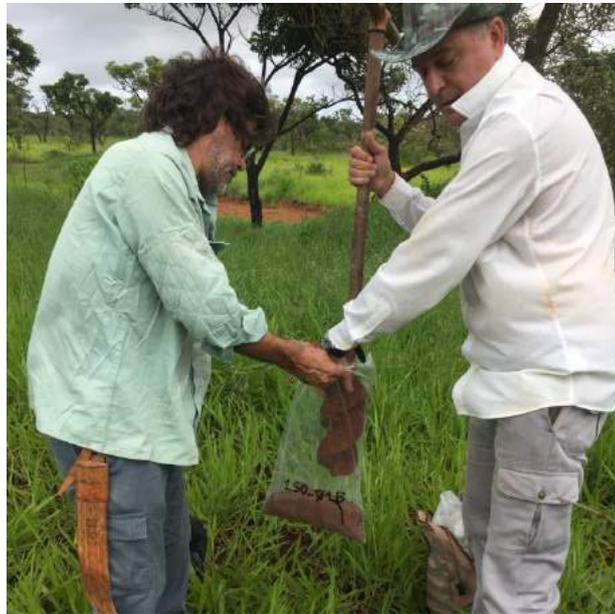
**Figura 44** - Amostragem de solo em profundidade de 60 cm com auxílio de trado manual.
