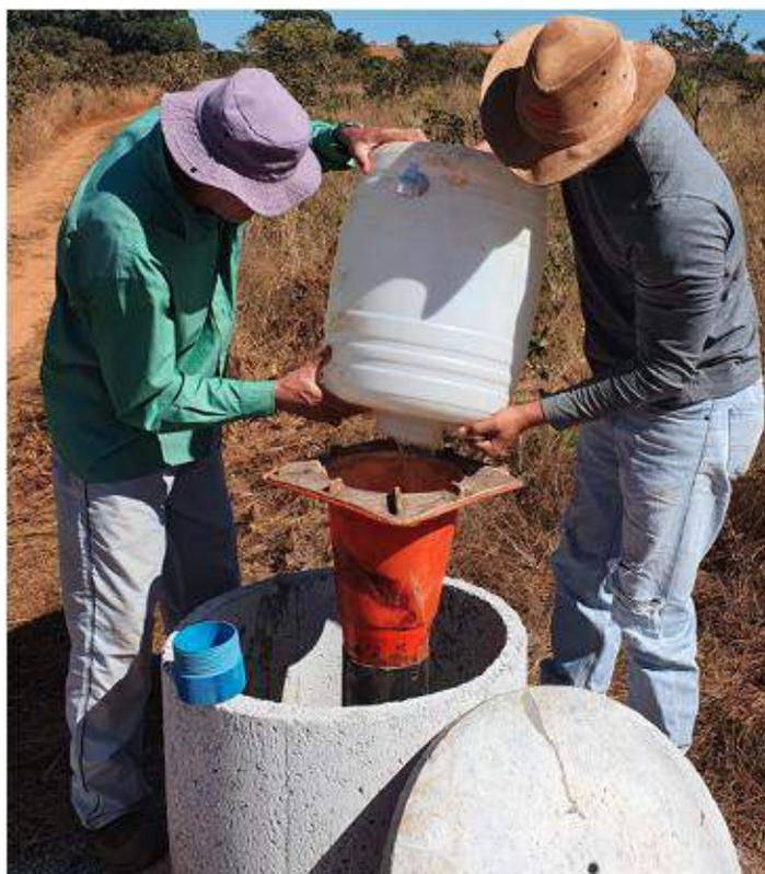
**Figura 55** - Adição de água ao poço a fim de se elevar o nível estático para averiguação das condições de recuperação.
