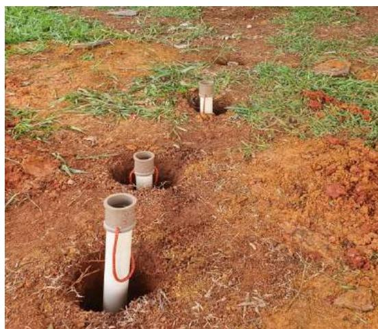
**Figura 54** - Ensaio de infiltração *in situ* com método *Open End Hole*.
