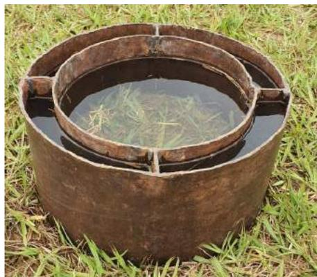
**Figura 53** - Ensaio de infiltração *in situ* com o método dos anéis concêntricos.
