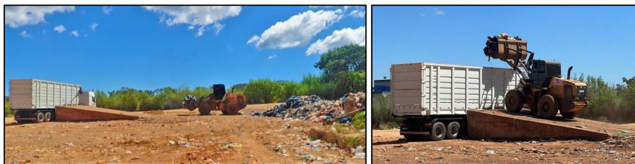
Figura 32: Pá carregadeira se direcionando à rampa para posterior carregamento da carreta (esquerda). Abastecimento da carreta (direita).
