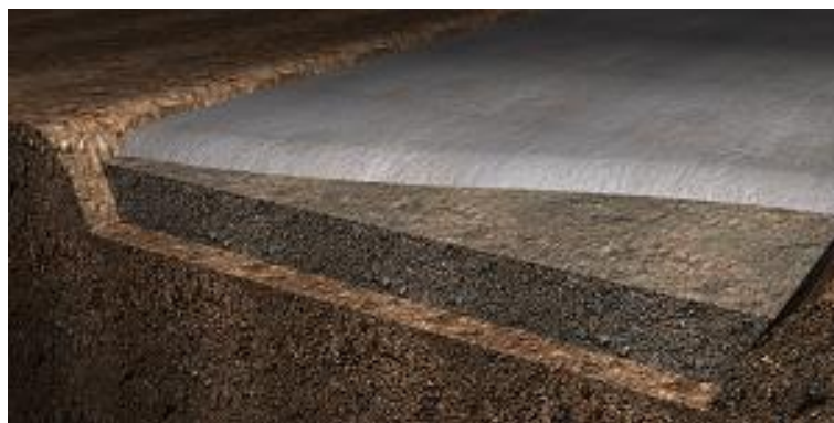
Figura 16 - Piso contínuo de concreto tratado.
