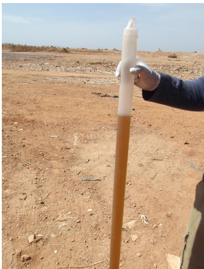
Figura 2 - Coleta de chorume em poço de monitoramento no interior da URE com auxílio de amostrador tipo “bailer”.
