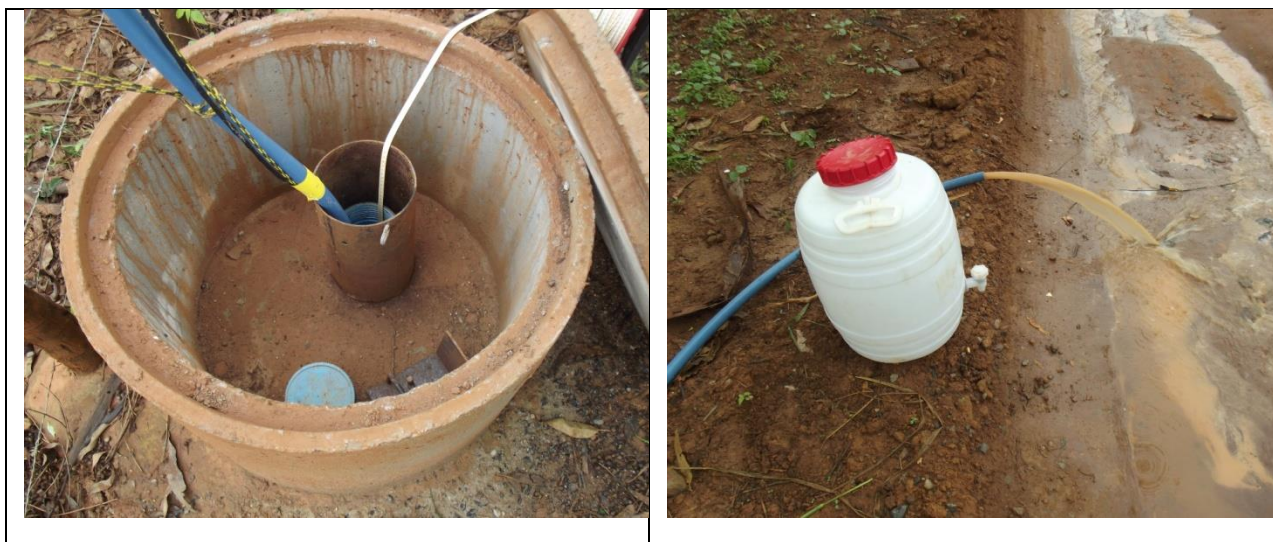
Figura 8 - Teste hidráulico para determinação das condições de rebaixamento no Poço de Monitoramento LX-12, com bombeamento e medição simultânea do rebaixamento e da vazão de efluentes.
