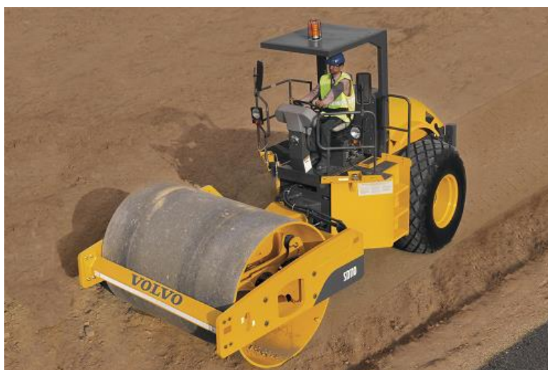
Figura 14 - Compactador monocilíndrico vibrante autopropulsado.
