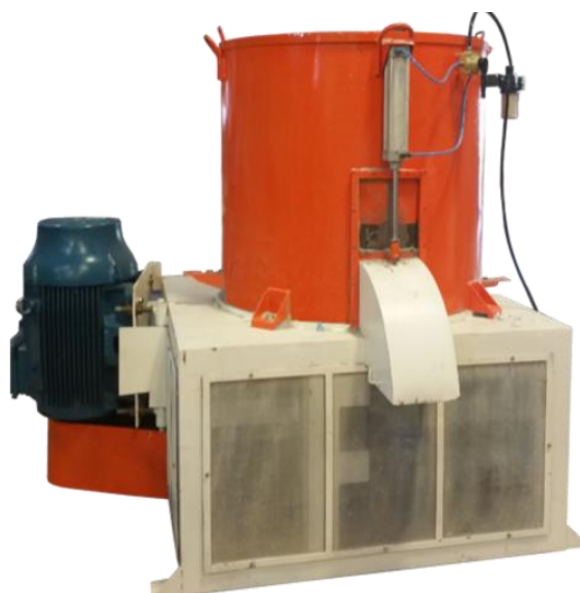
Figura 34 - Vista geral de um aglutinador de plástico reciclado, da Plastimax Máquinas.
