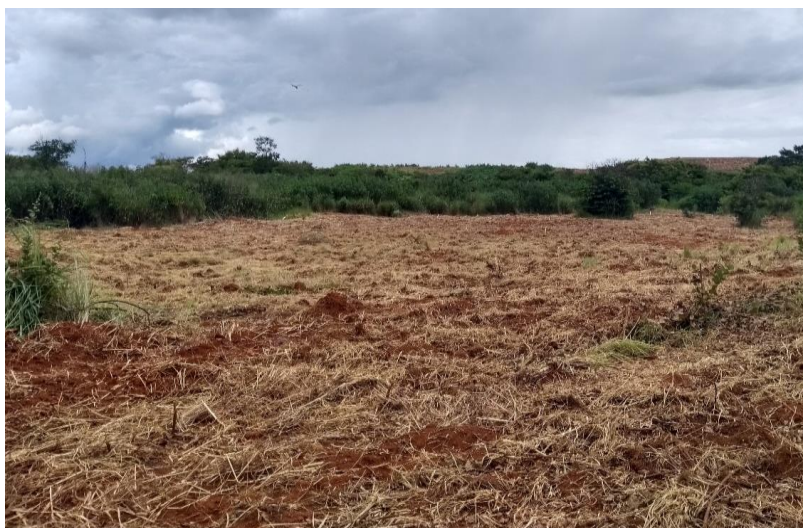
Figura 5 - Preparação do solo para a realização do experimento de estabilização de metais no solo com aragem e gradeamento (março de 2020).
