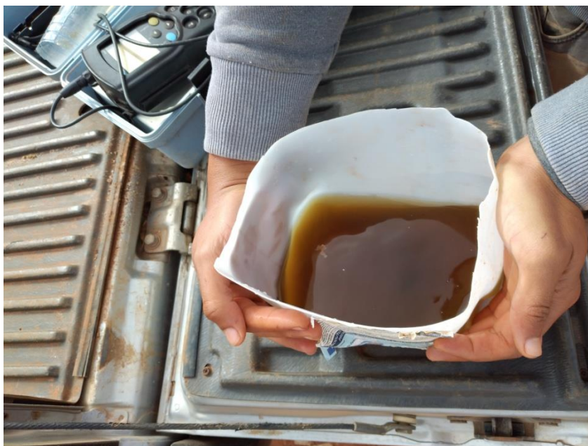
Figura 1 - Coleta de chorume em poço de monitoramento situado na porção central da pilha de aterro. Notar a cor escura do efluente com condutividade elétrica de 14.000 \mu\text{S}/\text{cm} (maio de 2020).
