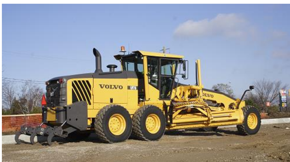
Figura 13 - Exemplo de motoniveladora de 99 kW, equipada com fresa.
