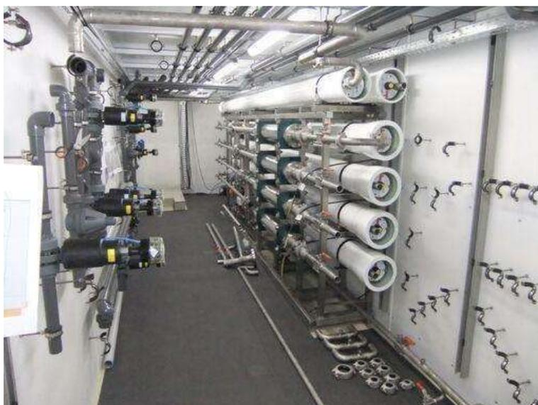
Figura 14 – Exemplo de um Sistema de OR em montagem na fábrica da AST.
