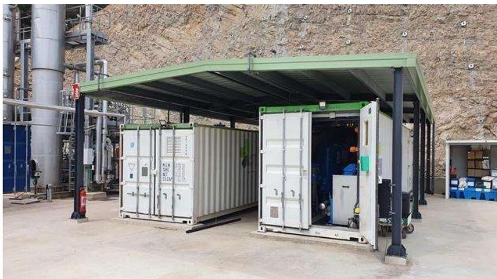
Figura 17 – Tratamento de chorume em Sistema de OR em três etapas, caudal de 250 m<sup>3</sup>/d, Sistema OR de redução de concentrado e evaporação, UTE Giref, Ibiza, Espanha.
