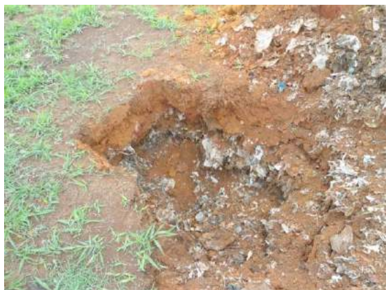
Figura 16 - Área 1 – Perfil de um latossolo vermelho-amarelo (perfil 1): 0 a 25 cm solo; 25cm a 1m lixo. Coordenada SICAD – Sirgas 2000 E: 164634.2922 N: 8245879.7925
