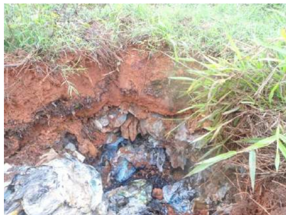
Figura 35 - Área 5 – Perfil de solo 20: 0 a 25 cm de solo; 25 cm a 90 cm de lixo. Coordenada SICAD – Sirgas 2000
