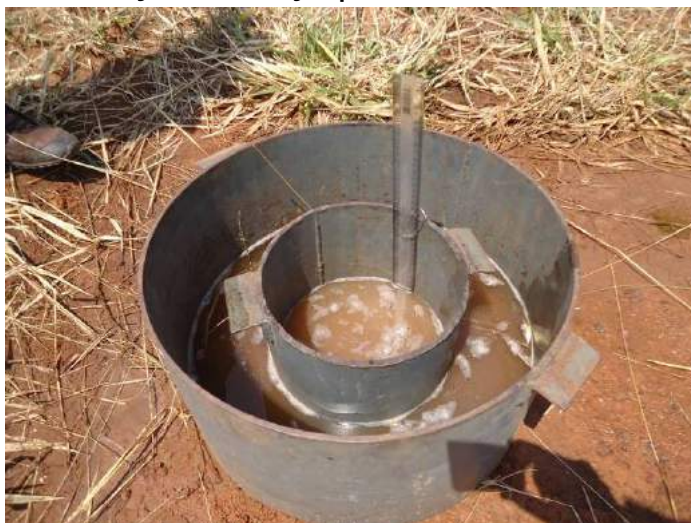
Figura 86 - Medição de infiltração pelo método dos anéis concêntricos.
