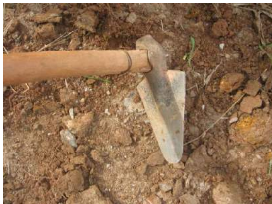
Figura 155 - Ferramenta manual utilizada para o microcoveamento dos taludes para receber a hidrosemeadura.
