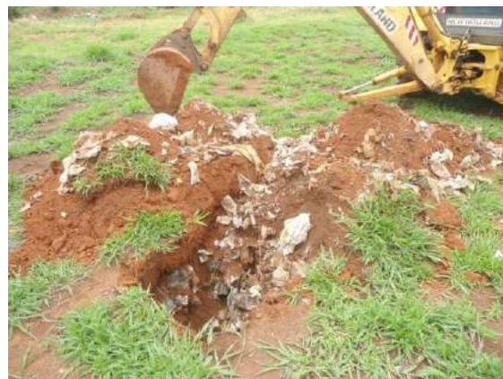
Figura 17 - Área 1 – Perfil de solo 2: 0 a 36 cm solo; 37cm a 1m lixo. Coordenada SICAD – Sirgas 2000 E: 164547.4174 N: 8245899.9211
