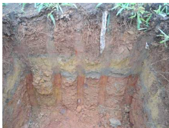
Figura 25 - Área 4 – Perfil de solo 10: 0 a 70 cm de solo até a rocha. Coordenada SICAD – Sirgas 2000 E: 164251.2381 N: 8245356.6759
