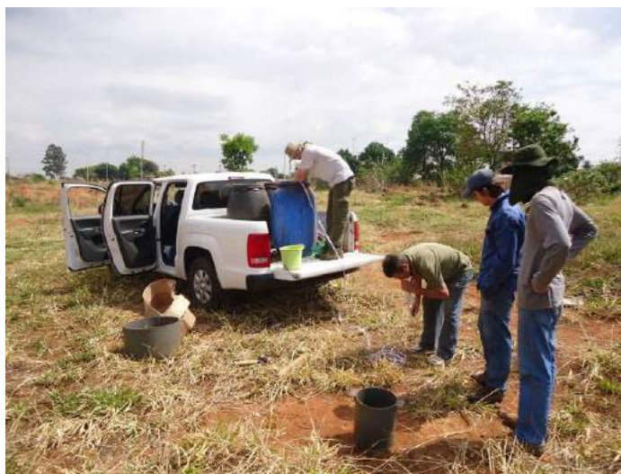
Figura 85 – Medição de infiltração pelo método dos anéis concêntricos.
