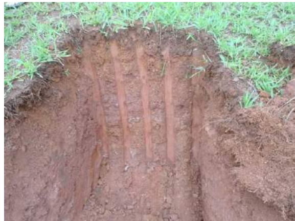
Figura 29 - Área 4 - Perfil de solo 14: 0 a 1,10m de solo Coordenada SICAD – Sirgas 2000 E: 164074.3611 N: 8245152.1702
