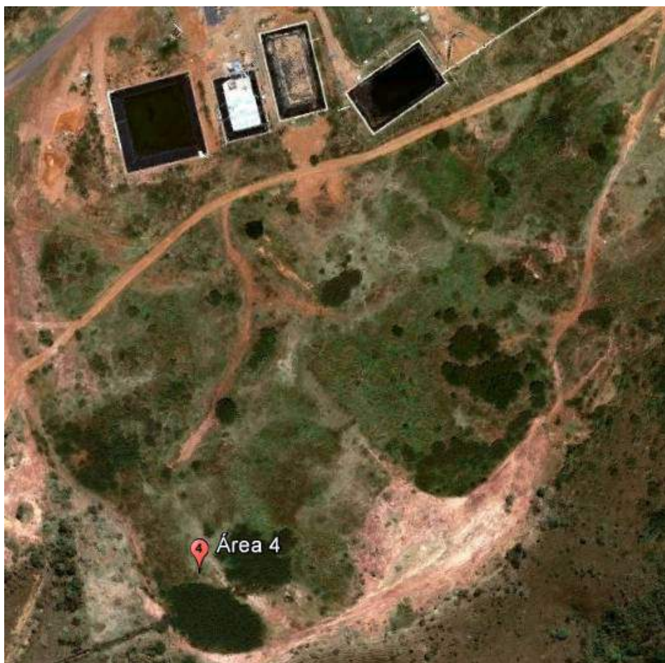
Figura 163 - Imagem orbital indicando abaciamento, dissipador de energia áreas de solo exposto em borda de chapada na área do SLU em Ceilândia. Fonte: Google earth 2012. Imagem de 06/10/2008.
