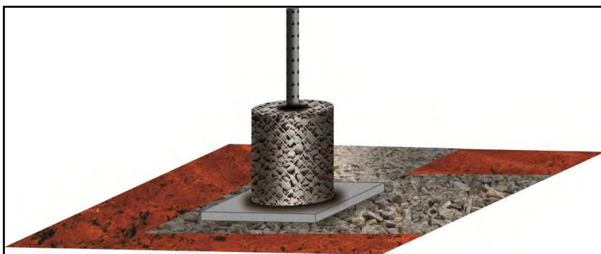
Figura 02: Dreno de biogás interligado ao sistema de drenagem de percolados
