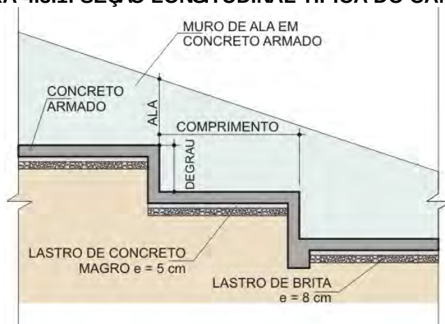
FIGURA 4.3.1: SEÇÃO LONGITUDINAL TÍPICA DO CANAL EM DEGRAUS
